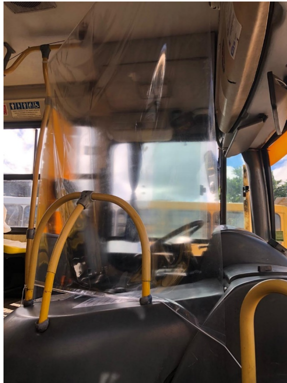
Figura 5. Barreira de Proteção entre motorista e passageiros Fonte: G1 (2020)
